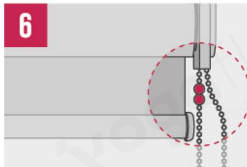
Para um ajuste de regulagem de altura mais fino, utilize a bola limitadora. Retire e coloque novamente a bola até chegar no ajuste desejado. Obs.: a bola limitadora não deve ser regulada num tamanho maior do que a altura da sua persiana.
